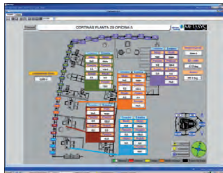
BMS. Supervisión de sistemas de protección solar. Imagen propiedad de Torre Iberdrola AIE
