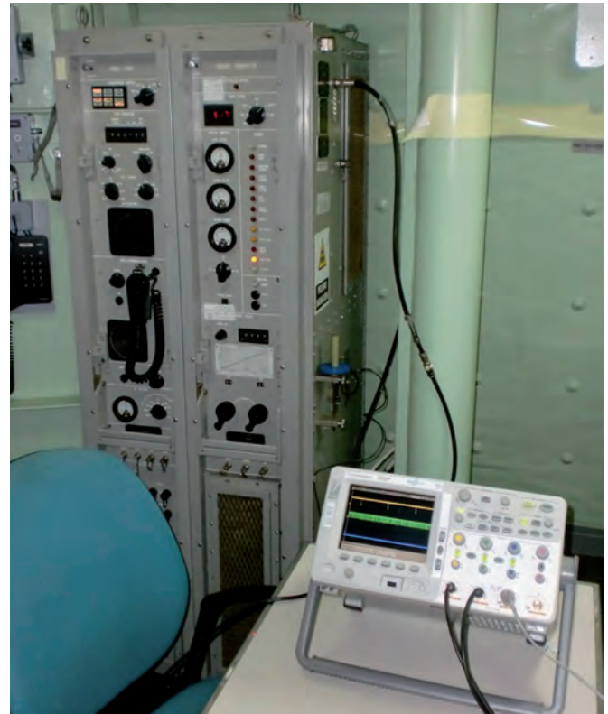
Fig. 18: Sistema TACAN y adquisición de la señal transmitida
