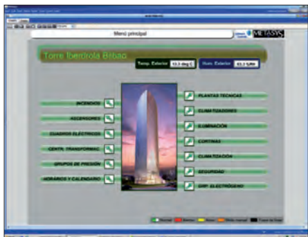
BMS. Relación de disciplinas supervisadas. Imagen propiedad de Torre Iberdrola AIE
