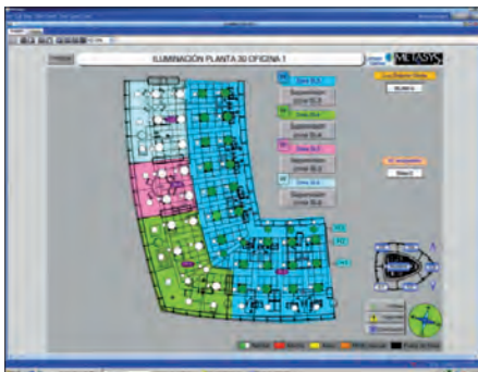
BMS. Supervisión de zonas de alumbrado. Imagen propiedad de Torre Iberdrola AIE
