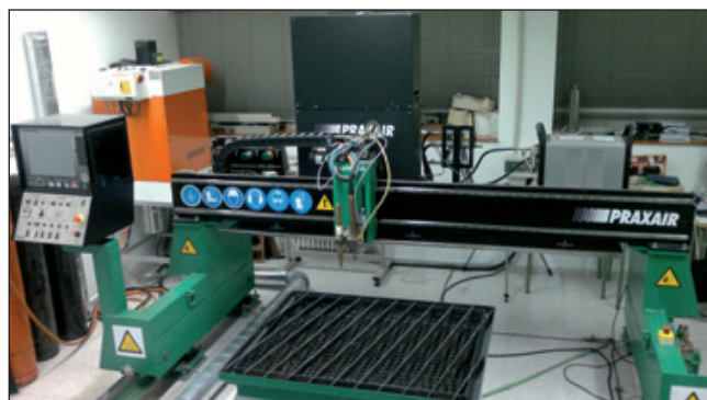
Fig. 2: Máquina de corte por plasma / oxigás utilizada en la prueba.
