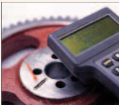
Figura 4. Transponder RFID de campo fuerte halo vidrio pegado al metal.
