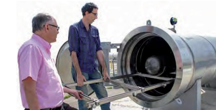
Técnicos de Ensayo Criogénico del Hidrógeno observando un depósito en el interior del contenedor de hidrógeno criogénico
