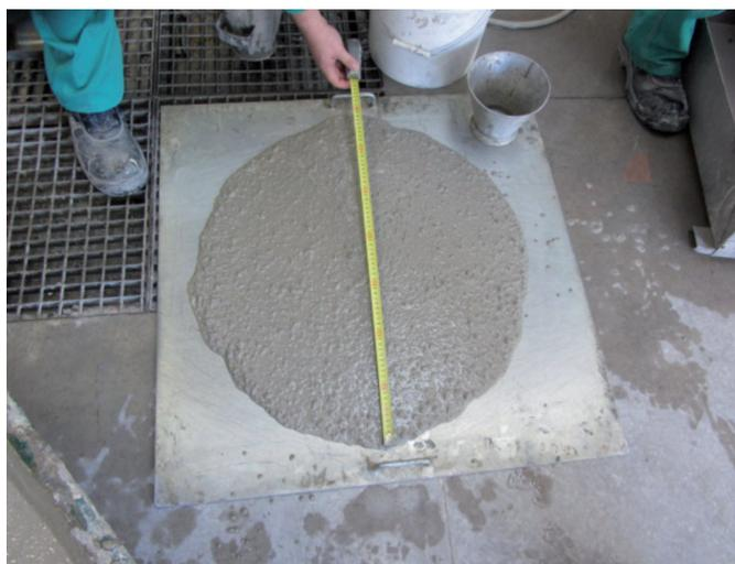
Fig. 1: Detalle de la torta durante el ensayo de escurrimiento
