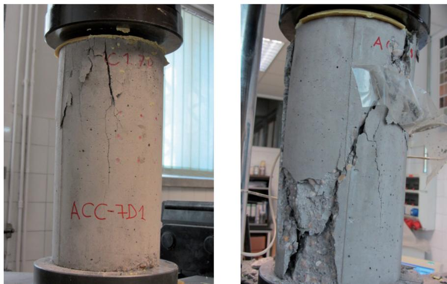
Fig. 2: Rotura de probeta cilíndrica ensayada a compresión
