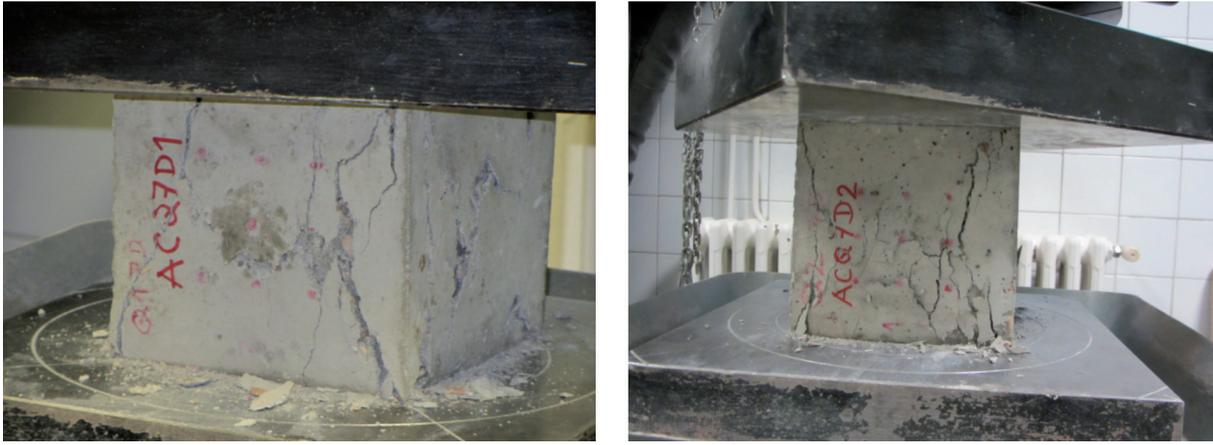
Fig. 3: Rotura de probeta cúbica ensayada a compresión
