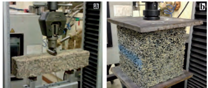
Fig. 1: (a) Ensayo de flexión; (b) Ensayo de compresión
