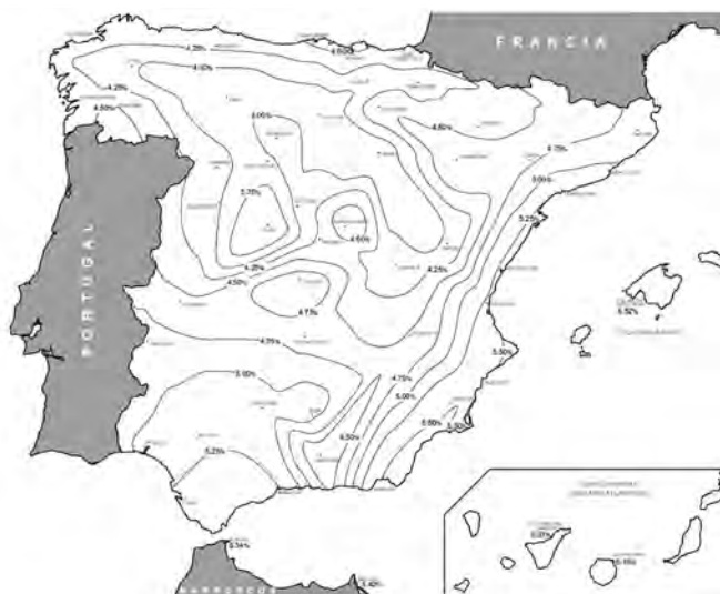
Fig. 3: Mapa de corrección para la conductividad térmica de materiales de fachada (incremento porcentual del valor \lambda_{lb} )
