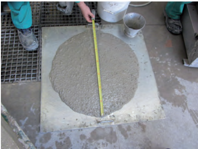
Fig. 1: Detalle de la torta durante el ensayo de escurrimiento
