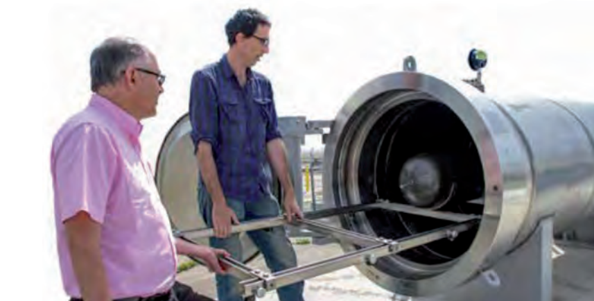
Técnicos de Ensayo Criogénico del Hidrógeno observando un depósito en el interior del contenedor de hidrógeno criogénico
