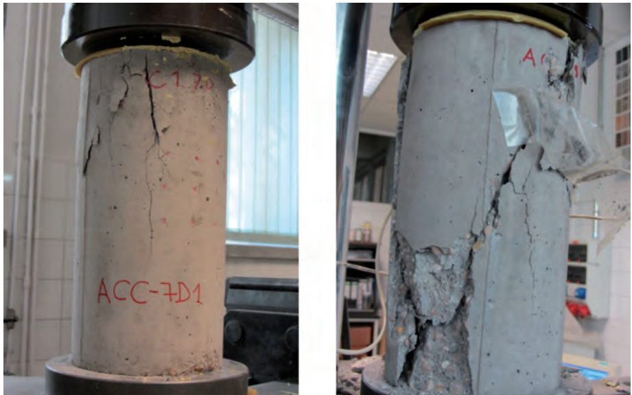
Fig. 2: Rotura de probeta cilíndrica ensayada a compresión
