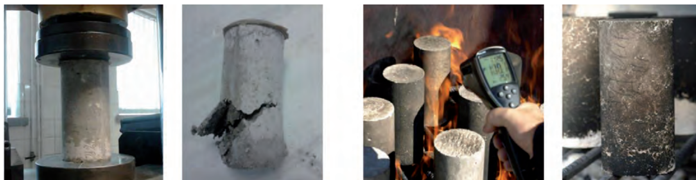
Fig. 1: a) Ensayo de resistencia a compresión, pre-factura y fisuración de la matriz del hormigón con fibras; b) Ensayo a fuego directo y probeta de hormigón después del incendio
