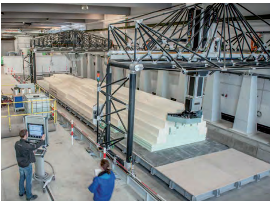
En el Centro de Ensayos para Fabricación de Palas se pueden hacer por mecanización hasta ocho etapas del proceso en un mismo puesto de trabajo. A partir de los bloques apilados se crean las formas de las palas del rotor
