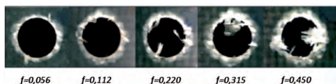
Fig. 2: Efecto del incremento de la velocidad de avance en la delaminación a la salida de la herramienta [4] (datos en mm/rev)
