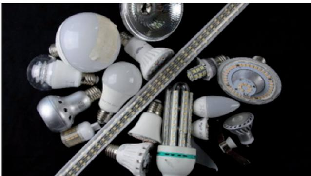
En los aparatos modernos de iluminación se incorporan diferentes materiales: vidrio o plástico en las carcasas, cerámica o aluminio en los cuerpos de refrigeración, cobre en contactos o cables, y los más valiosos en el interior de los diodos emisores de luz – los conocidos como LED (*Light Emitting Diode*): indio y galio en el diodo semiconductor y tierras raras, como europio o terbio en el luminiscente. La fabricación de los diodos es por eso apreciablemente cara y los márgenes son muy bajos.
