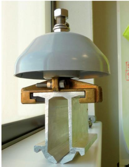
Fig. 7: Soporte unificado de catenaria rígida
