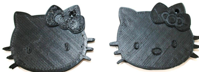
Fig. 8. Ejemplo de impresión 3D. A la izquierda la primera impresión obtenida, a la derecha la pieza obtenida tras los ajustes necesarios en la impresora 3D
