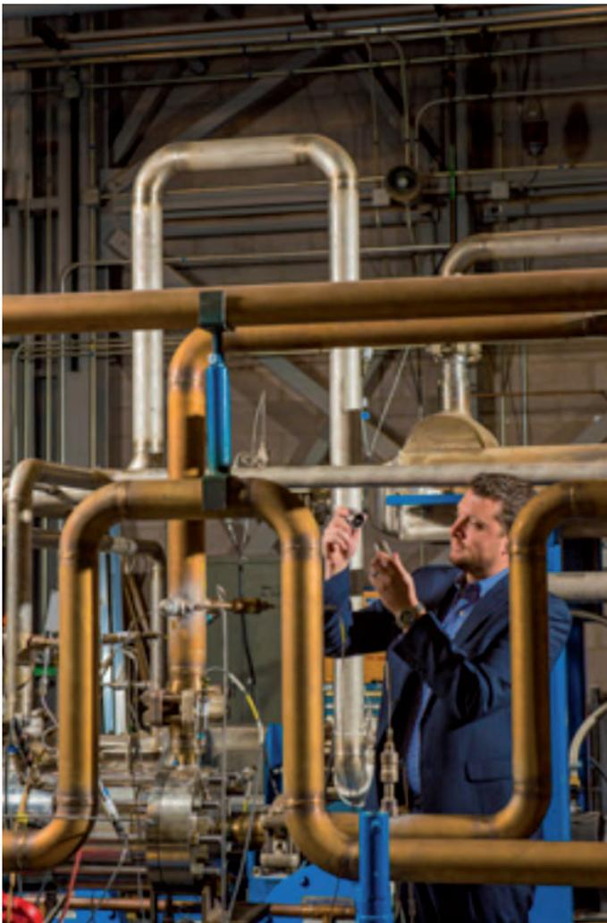
El investigador principal de Sandia, Darryn Fleming, rodeado del equipo térmico de laboratorio de 1 MW con ciclo Brayton S-CO<sub>2</sub>
