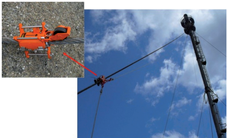
Fig. 10: Cabeza magnética para análisis magneto inductivo, desplazándose por cable de antorcha
