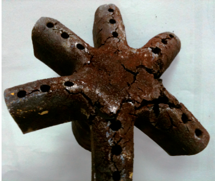
Fig. 8.3: Detalle de una boquilla dañada por altas temperaturas
