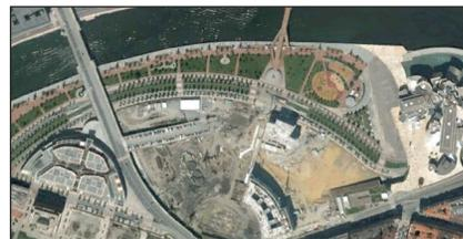
6 Agosto 2007. En el interior del solar se encuentran los depósitos de recirculación de lodos de la hidrofresa. Comienza a marcarse en planta la geometría del bajo rasante. En el Sur de la parcela se observan las cimentaciones del aparcamiento situado bajo la plaza Euskadi. También se puede apreciar la galería de servicios situada en la calle Ramón Rubial
