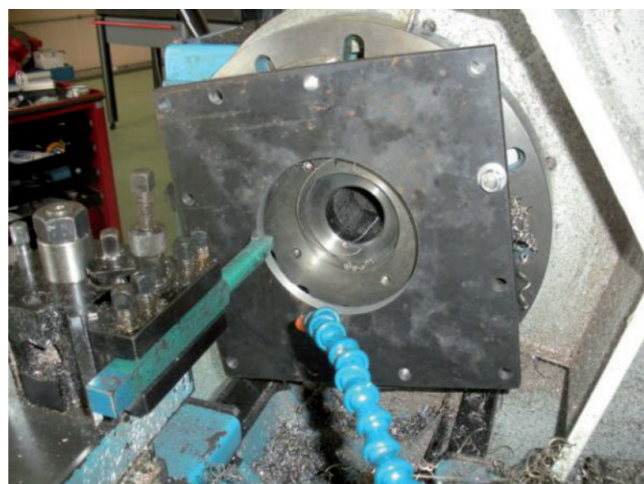
Fig. 10: Fabricación, mediante mandrinado, de hueco circular en placa soporte
