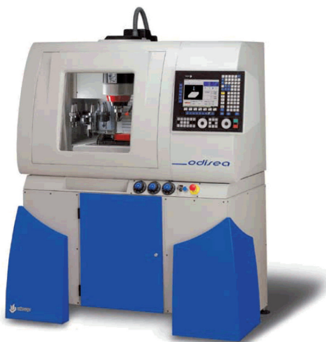
Fig. 8: Centro de mecanizado adaptado para realizar el proceso SPIF
