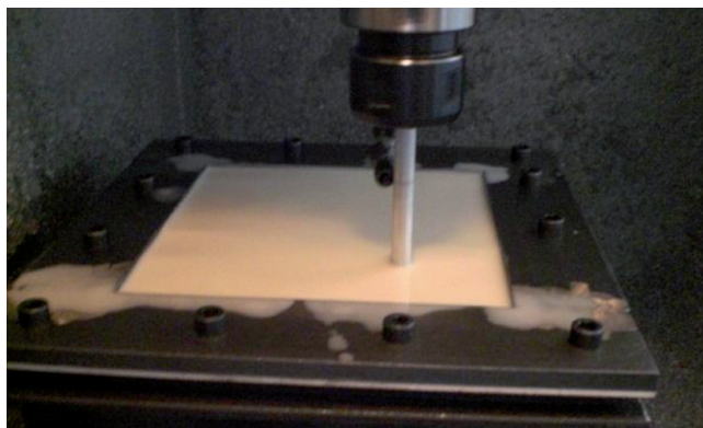
Fig. 16: Vista general del proceso SPIF. Refrigeración del proceso
