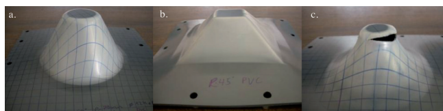
Fig. 3: Geometrías más utilizadas en los ensayos de SPIF: a) Tronco de cono; b) Pirámide truncada; c) Hipérbola.
