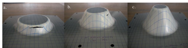
Fig. 11: Comprobación del ángulo máximo del material: a) 65°; b) 61°; c) 60°.
