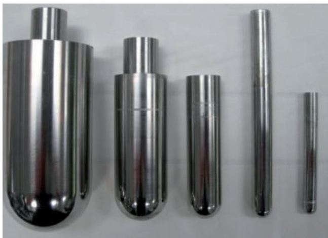
Fig. 5: Herramientas de distintos diámetros, utilizadas en procesos SPIF [17]
