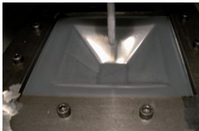
Fig. 1: Proceso de deformación incremental de una chapa
