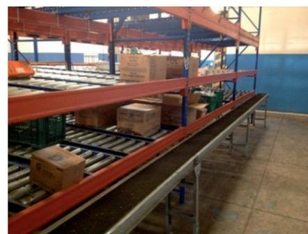
Fig. 2c: Instalación de racks carton-flow utilizados en el armado de despensas personalizadas desde el almacén
