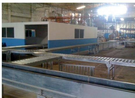
Fig. 2b: Instalación de transportadores para el manejo de alimento dentro del almacén en contenedores identificados por grupo nutricional.
