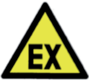
Fig. 1: Señal indicativa de zona clasificada con riesgo de explosión
