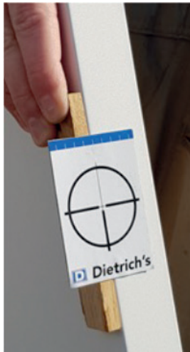
Fig. 1: Izda: diana objetivo que permite identificar los puntos de medida con una estación total; Dcha: puntos de medida alrededor de la ventana [Fuente: proyecto BERTIM]
