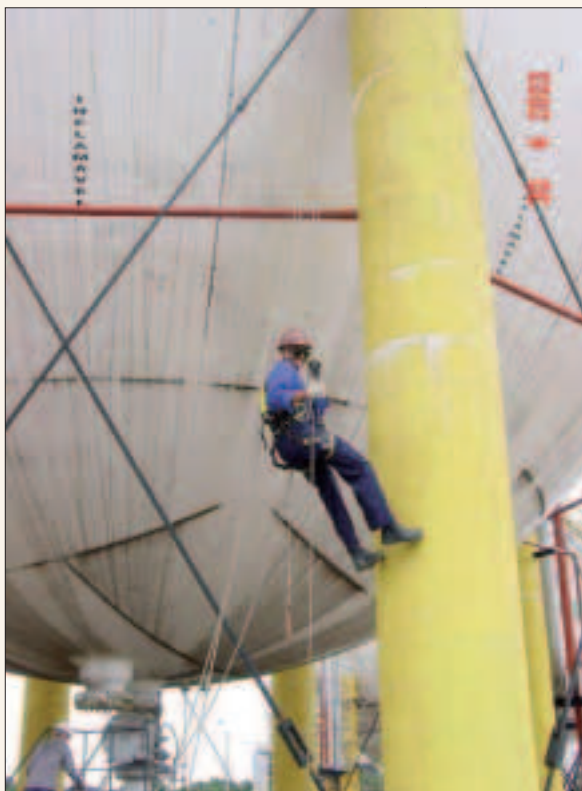
Figura 3: Operario (centro imagen) manejando la sonda de inspección mientras el inspector (esquina inferior izquierda) evalúa los datos obtenidos
