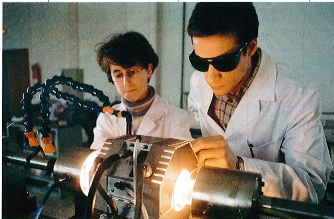
*Ensayo de torsión en caliente para estudiar la evolución microestructural de un acero durante el conformado en caliente.*
