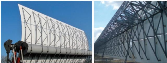
Fig. 6: Izquierda: Estructura con tubo de torsión. TERMOPOWER.
