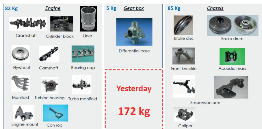
Piezas tradicionales de hierro fundido en el automóvil (peso medio por vehículo)
