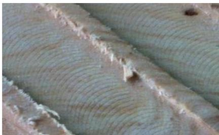
Fig. 7: Marcas dejadas por la herramienta en la madera durante el mecanizado de la ranura
