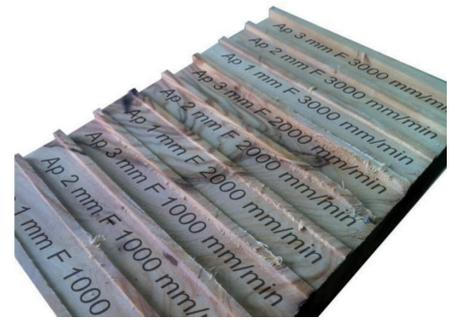
Fig. 5: Ejemplo de muestra con 34% humedad, utilizada durante los ensayos con velocidad de giro de 4000 rpm, y distintos valores de profundidad de pasada y velocidad de avance
