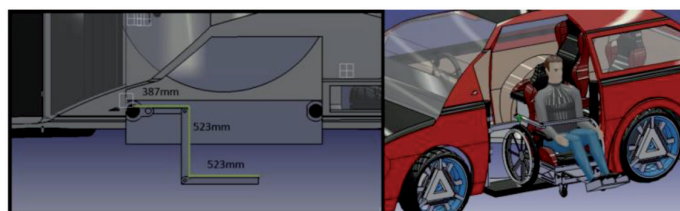
Fig. 10: Barrera de seguridad
