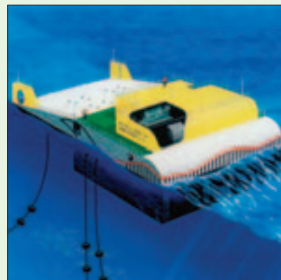
Instalación japonesa Mighty Whale : las olas comprimen aire en una cámara para el accionamiento de una turbina.
