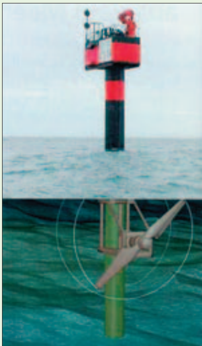
A tres km de la costa occidental británica, cerca de Lynmouth, en Devon, se encuentra la central marina Seaflow (Marine Current Turbines).
