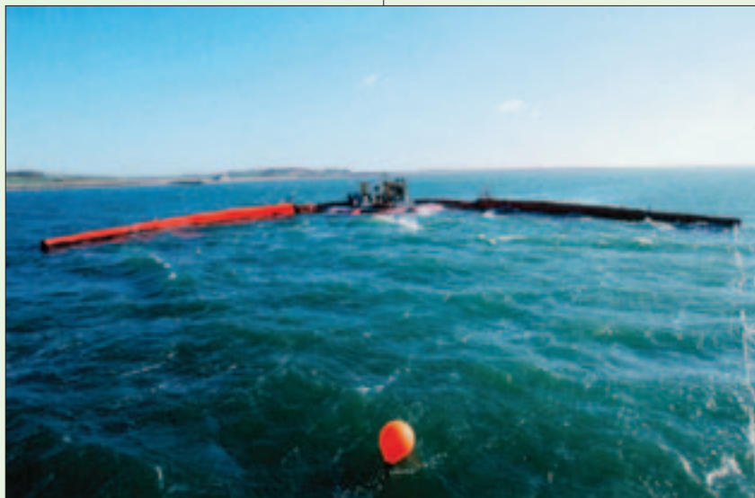
El ensayo de Wave Dragon, con 57 m de longitud y 261 toneladas de peso, se inició en marzo de 2003 (Foto Wavedragon)
