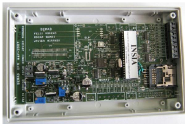
Figura 3: Dispositivo de registro de datos DIVAC
