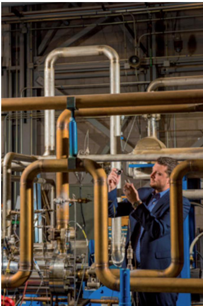
El investigador principal de Sandia, Darryn Fleming, rodeado del equipo térmico de laboratorio de 1 MW con ciclo Brayton S-CO 2
