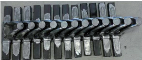
Fig. 10: Lote de 12 componentes híbridos obtenidos mediante tixofundido lateral
