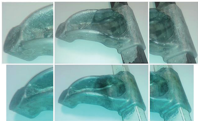
Fig. 13: Estructuras híbridas tras un tratamiento térmico T6 y detalles de la zona de la cabeza y de la zona de la unión
