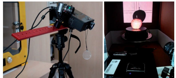
Fig. 3: a) Cámara del escáner 3D, b) Interior de la caja oscura en la que se incluye la plataforma giratoria
