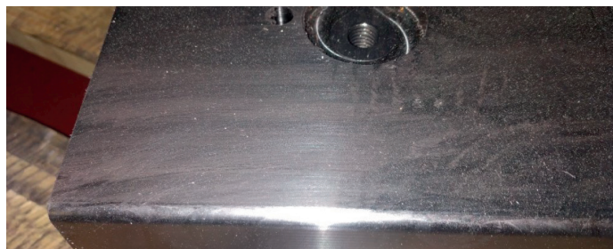
Fig. 8: Taco mecanizado hasta espesor efectivo de 1,5 mm
