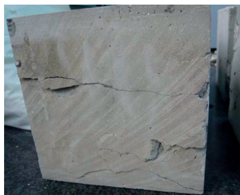
Fig. 7: Rotura de probeta de hormigón fabricada mediante impresión 3D
