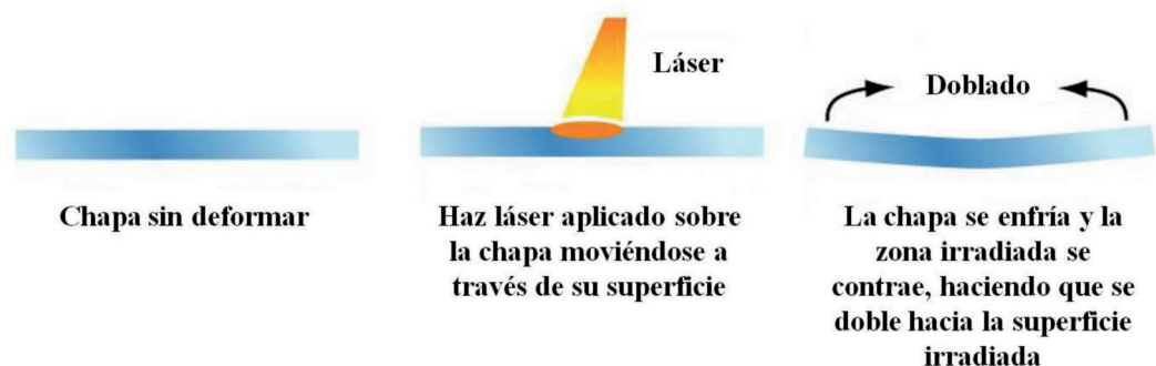
Figura 1: Mecanismo TGM de conformado directo por láser (DLF)
