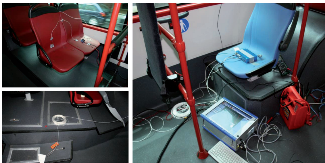
Figura A1: Sensores instalados y equipos de adquisición de datos en las fases iniciales de caracterización
