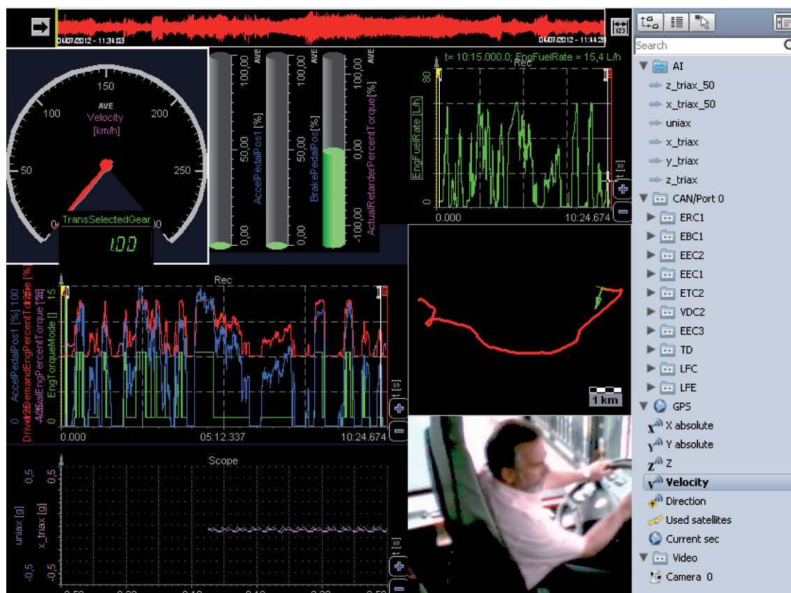
Figura A2: Captura de pantalla del sistema de adquisición de datos en los ensayos de calibración
