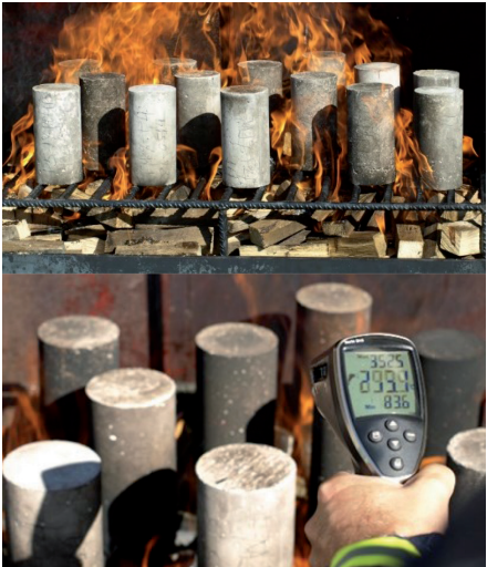
Fig. 1: Ensayo de temperatura a fuego directo
