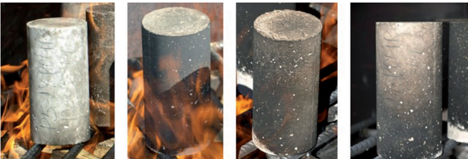
Fig. 2: Aspecto de las probetas de hormigón con fibras de polipropileno en el ensayo a fuego
