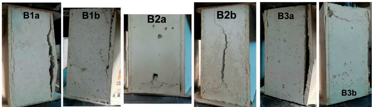
Fig. 6: Rotura a compresión de los bloques
